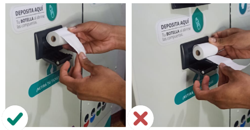
Fig. 13 Forma correcta e incorrecta de poner el papel térmico en la impresora
