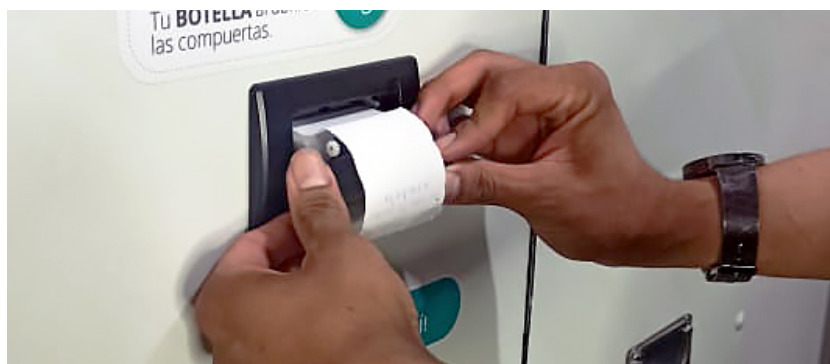
Fig. 9 Verificación de la impresora térmica
