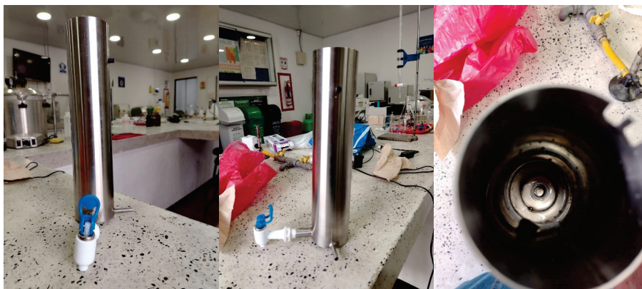
Figura 5. Reactor a escala piloto para el proceso Foto-fenton para la remoción de agroquímicos en solución acuosa.
