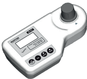
Figura 12. Medidor de turbiedad Martini Instrument
